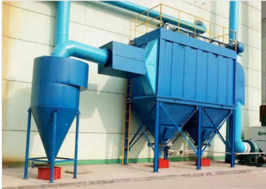
检查除尘布袋安装是否正确。布袋除尘器的除尘布袋是依靠缝制于滤袋口的弹性胀圈将滤袋嵌压在花板孔内，通过花板将过滤室和净气室严格区分。如果滤袋口的弹性胀圈未能与花板孔完全密合，出现了缝隙，就会导致含尘气体直接进入净气室，进而排放到大气中。因此需要逐一检查除尘布袋口的安装情况，发现缝隙需要压紧密封。目前对滤袋安装的改进优化是，安装滤袋后安装除尘笼骨，除尘笼骨尾部套圈略大于花板孔，安装笼骨后，既可以将笼骨挂在花板上，还可以使布袋与花板密合。
